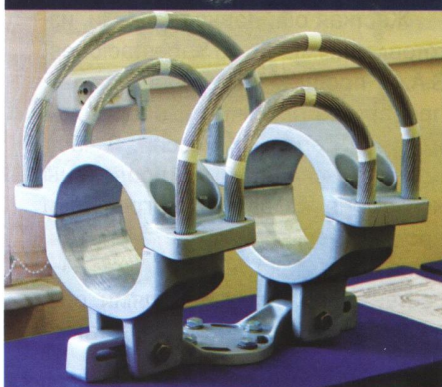
Рис. 10. Шинодержатель «Arruti Sabestaciones, S. A.» для труб диаметром 220 мм с номинальным током 3600 А
