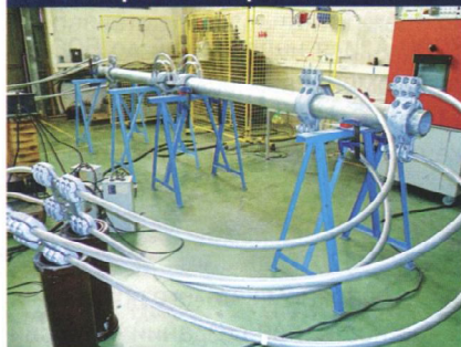
Рис. 8. Испытания узлов крепления жёстких и гибких проводников производства «Arruti Sabestaciones, S. A.» на нагрузочную способность в рабочем режиме
