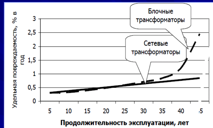
Удельная повреждаемость трансформаторов (по Львову М.Ю.)
