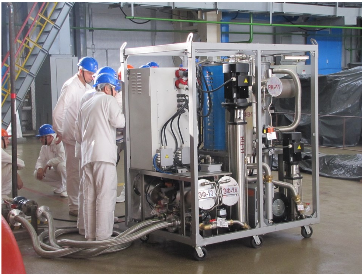
Рис. 3 Установка МЭФО-200 ООО «Микронинтер» в процессе очистки турбинного масла.
