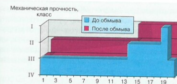
Рис. 9. Прочность образцов бумажной изоляции (со степенью полимеризации D1 менее 400 ед.) D1 — до и D2 — после проведения ремонта
