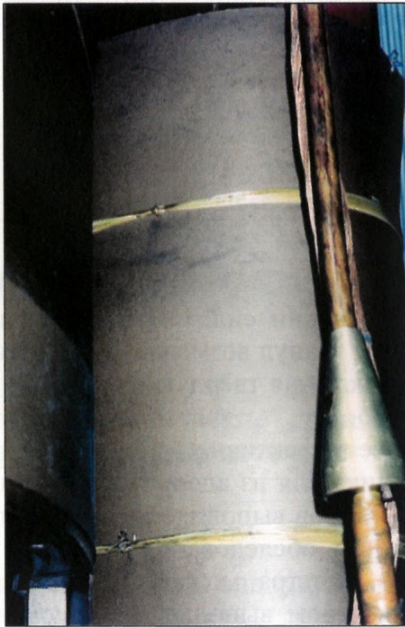
Рис. 2. Загрязнение углеродом твёрдой изоляции трансформатора ТДЦ-250000/500 при развитии дефекте магнитной системы
