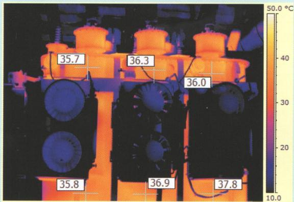
**Рис. 2. Термограмма поверхности бака трансформатора со стороны вводов ВН**
