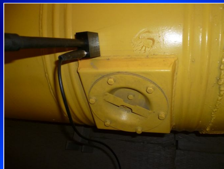
Обследование каждого пояса изоляторов токопровода акустическим и индукционным методом приборами AR200 и R400
