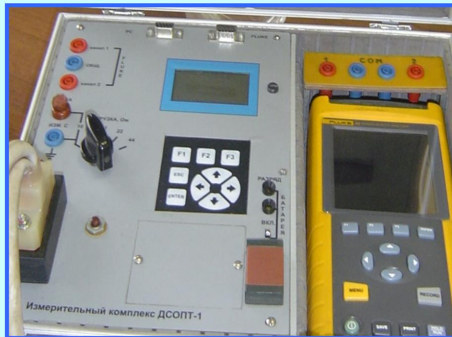
**Основное средство измерения токов КЗ в СОПТ (без отключения оборудования), ёмкости сети на «землю».**
