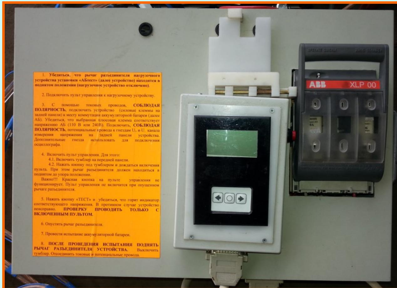
**Основное средство измерения внутреннего сопротивления аккумуляторной батареи двухимпульсным методом без вывода её из работы.**
