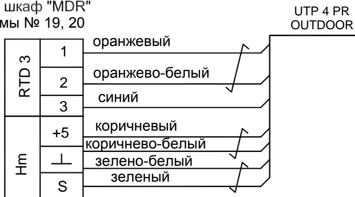
Рисунок 14. Подключение датчика “SCI-1”.
