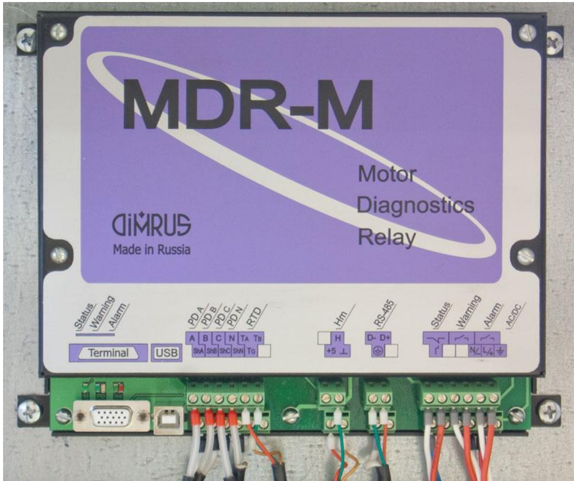
Рисунок 1. Внешний вид прибора MDR-M
