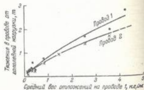
Рис. 3. Зависимость тяжений в проводах расщепленной фазы, вызванных гололедной нагрузкой, от среднего веса осадка на проводе 1.
