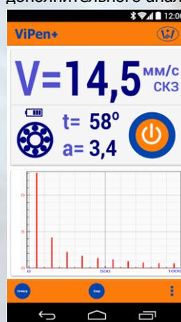
Прибор ViPen+ расширенной версии оснащается беспроводным интерфейсом Bluetooth, при помощи которого информация передается на смартфон или на планшет на расстояние до 3 метров.
