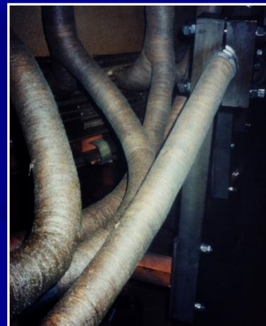
Загрязнение активной части трансформатора силикагелевой пылью
