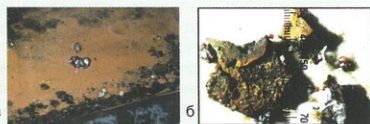
Рис. 3. Шлам на дне бака трансформатора АТДЦТ- 250000/330/150 (а) и фрагмент образца шлама примерно при 50-кратном увеличении (б)
