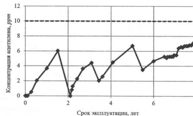
Рис. 6. Изменение концентрации ацетилена в масле трансформатора ОРЦ-533000/500/15,75
