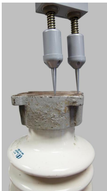
Рисунок А8 – Установка щупов на торцевой поверхности верхнего фланца
