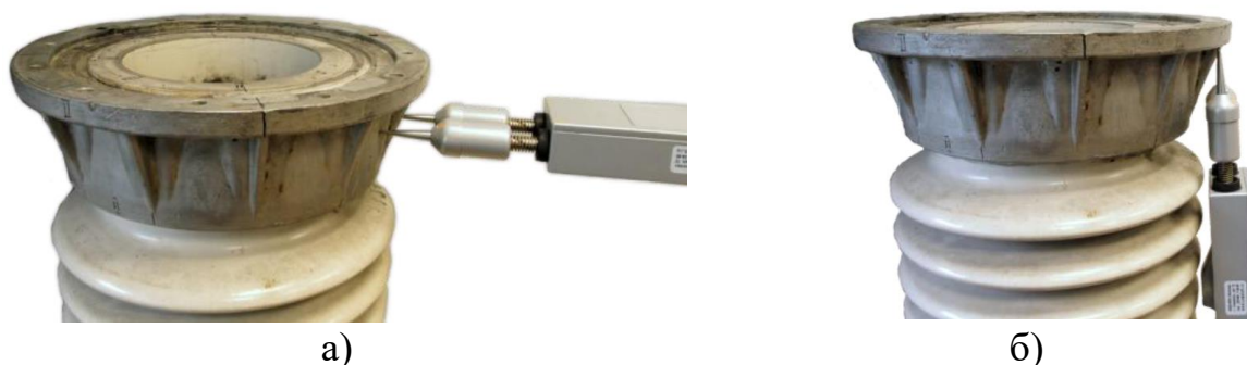
Рисунок А9 – Установка БР на фланец покрышки выключателя
