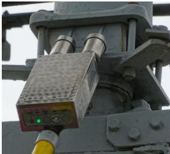
Рисунок А1 – Установка наконечников щупов блока регистрации на пластину крепления нижнего фланца изолятора
