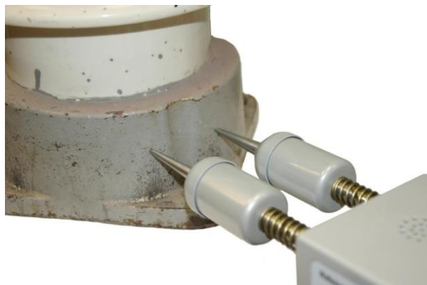
Рисунок А6 – Установка щупов (а – на приливах крепежных проушин; б – на боковой поверхности фланца)
