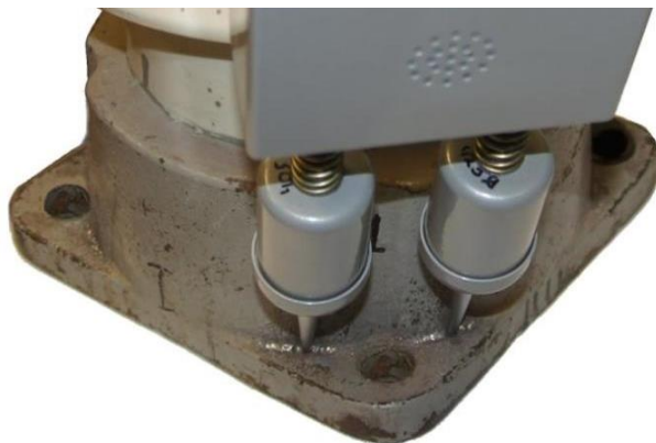
Рисунок А6 – Установка щупов (а – на приливах крепежных проушин; б – на боковой поверхности фланца)
