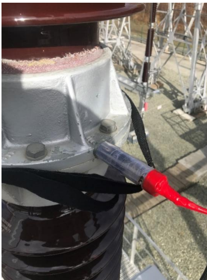
Рисунок В3 – Крепление контактного датчика к немагнитному фланцу
