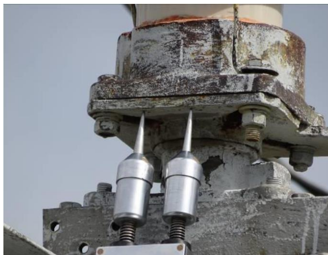
Рисунок А1 – Установка наконечников щупов блока регистрации на пластину крепления нижнего фланца изолятора
